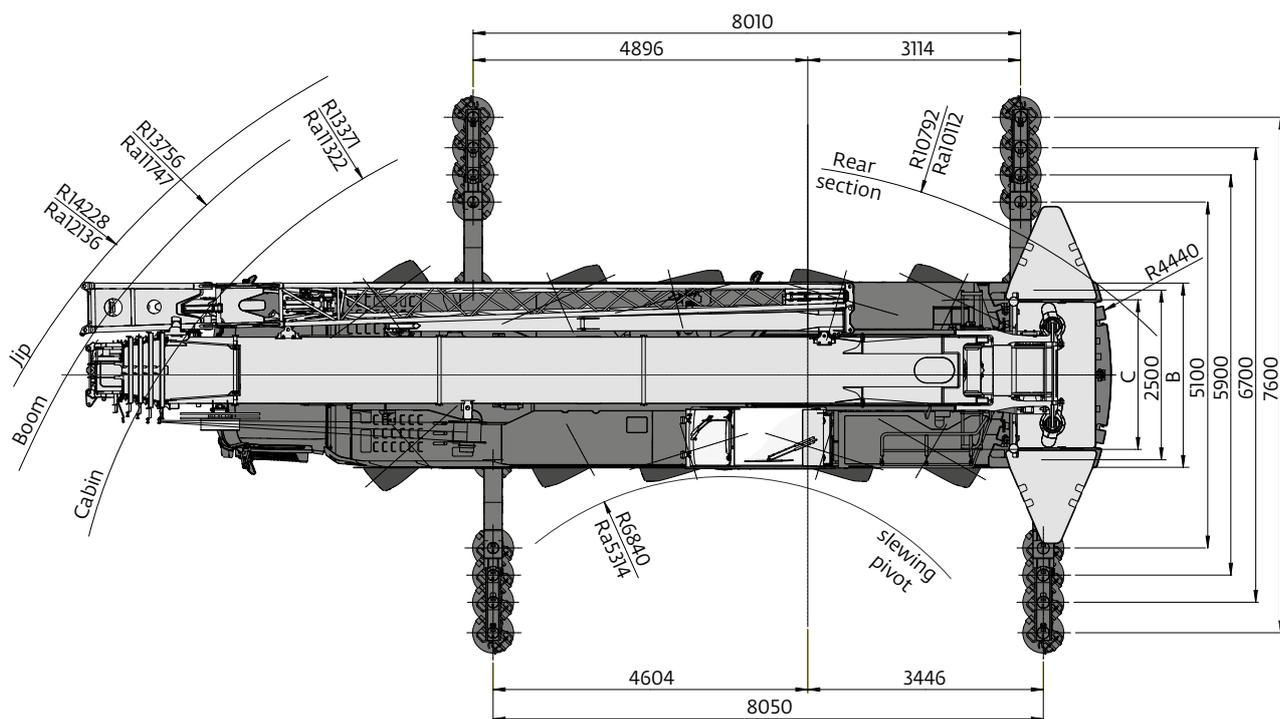
R<sub>a</sub> = Radius all wheels steered • Radius allradgelenkt • Rayon toutes les roues directrices • Radio de giro con todas las ruedas giradas • Raggio di curva con tutte le ruote sterzate
